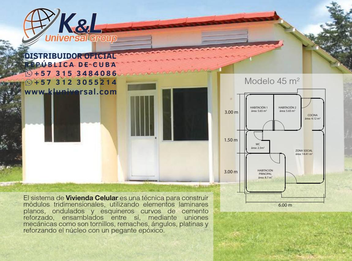
El sistema de **Vivienda Celular** es una técnica para construir módulos tridimensionales, utilizando elementos laminares planos, ondulados y esquineros curvos de cemento reforzado, ensamblados entre sí, mediante uniones mecánicas como son tornillos, remaches, ángulos, platinas y reforzando el núcleo con un pegante epóxico.
